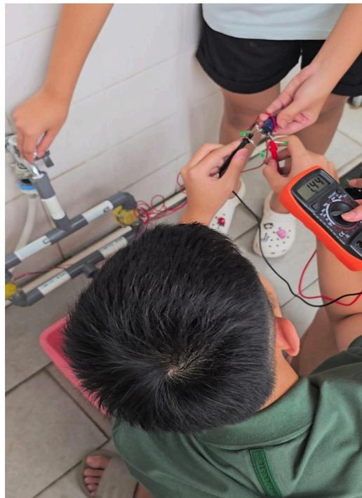
**Lampiran 11. Menguji Rangkaian Paralel dan Mengukur dengan Avometer Setelah Mengubah Rangkaian LED (2)**
