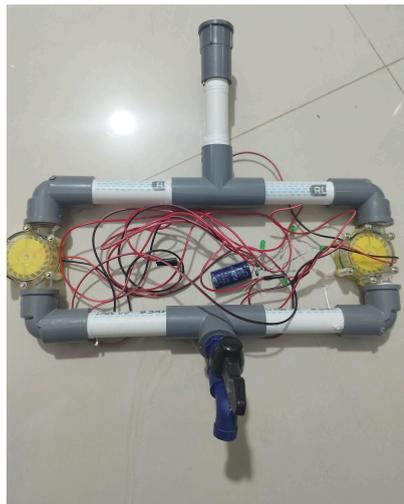
**Gambar 3.4 Rangkaian Paralel Lengkap**
