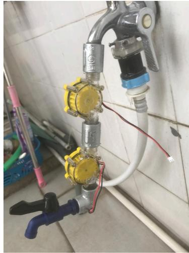
**Gambar 3.2 Rangkaian Seri (Generator tidak dengan komponen listrik)**
