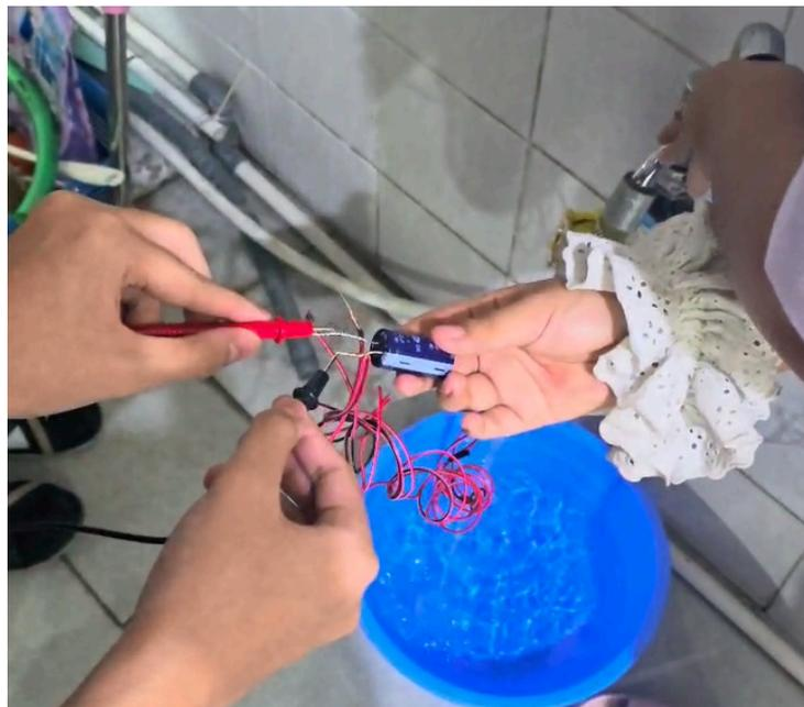
**Lampiran 3. Menguji Generator yang Terhubung ke Komponen Listrik dengan Avometer**
