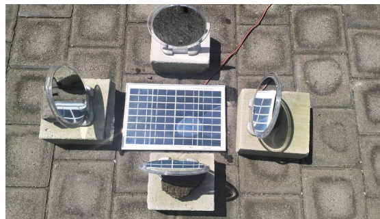
Lampiran 4. Panel Surya Menggunakan Cermin Cekung 70°
